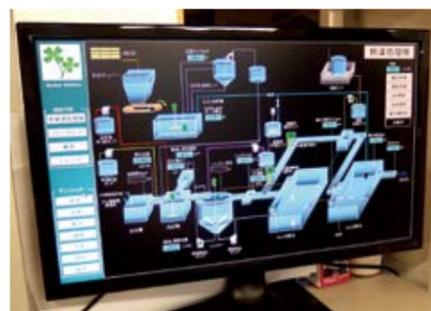
このような維持管理にかかる負担の軽減のために、現在主要な処理施設は遠隔監視を行い、モニタリング状況の自動記録、濁度異常や停電の際には自動通報するシステムを取り入れて、業務の効率化を図っています。
