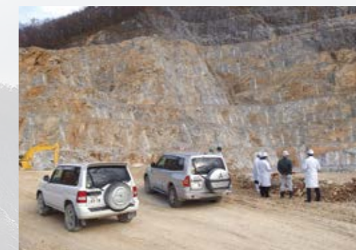
露天採掘でのベンチカット採掘法により、石灰石が採掘・生産されています
