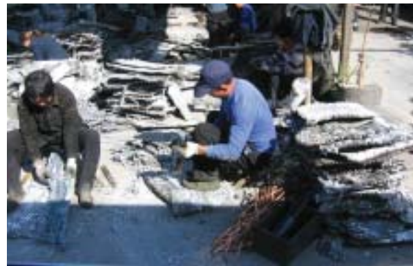
スクラップは手分別で徹底的に分解・資源回収される
